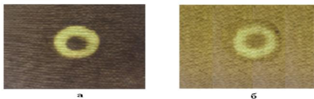
Рис. 1. Фотохимические пленки на образцах ткани со стороны, обращенной к солнечному излучению (а) и с противоположной стороны (б).
