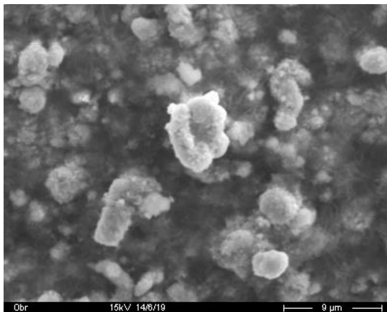
Рис. 2. СЭМ-изображение медного композиционного супергидрофобного покрытия с частицами SiC
