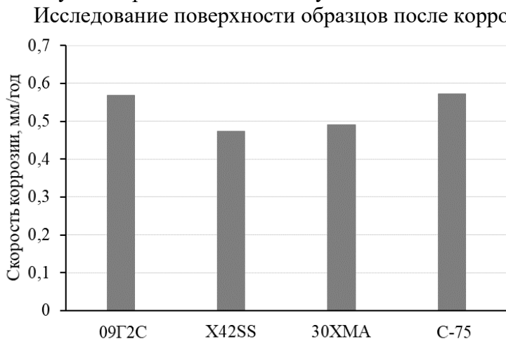
Рис. 1. Скорость коррозии сталей в модельной воде с минерализацией 240 г/л, P(\text{CO}_2) = 0,13 МПа, P(\text{H}_2\text{S}) = 0,54 МПа. Температура 30 °С, продолжительность испытаний - 120 ч.
