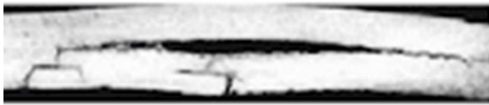
Рис. 4. Ступенчатое растрескивание стенки трубы
