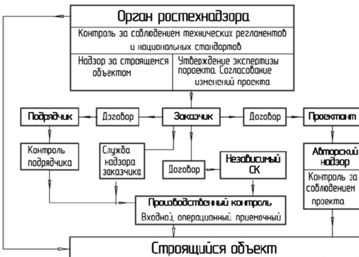
Схема организации строительного контроля на ОПО
