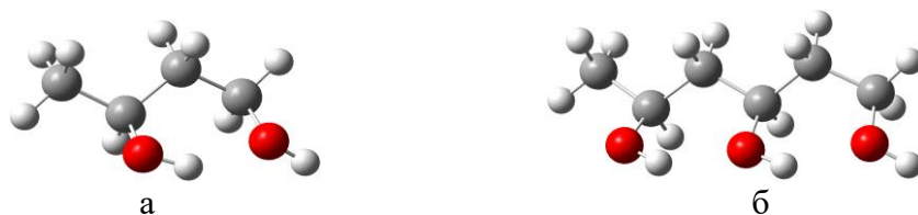
Рис. 3. Минимальноэнергетические конформации модельных димера (а) и тримера (б) ПВС (метод В3LYP/6-31+G(d))
