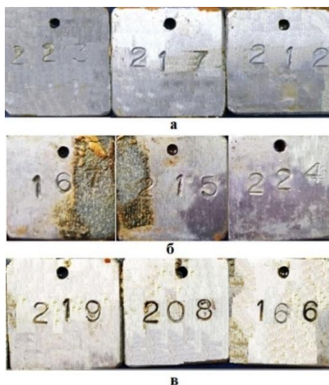
Рис. 1. Внешний вид образцов стали Ст3, покрытых масляными составами на основе И-20А (а), М-10Г2(к) (б), ММО (в) с 5 масс.% Cortec VpCl-369 после испытаний в 0,5 М растворе NaCl (456 час)
