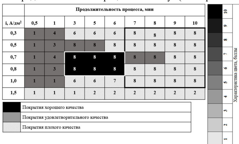
Рис. 1. Влияние продолжительности процесса и плотности тока на внешний вид покрытий (рН = 4,9, t_{p-pa} = 55-60^\circ\text{C} , t_{сушки} = 50^\circ\text{C} )
