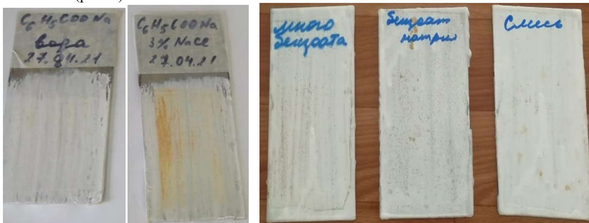
Рис. 1. Пластины, покрытые грунтовкой с бензоатом натрия, в воде (слева) и 3 %-ном растворе NaCl.
